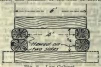
Fig. 2.-Log Culvert.
